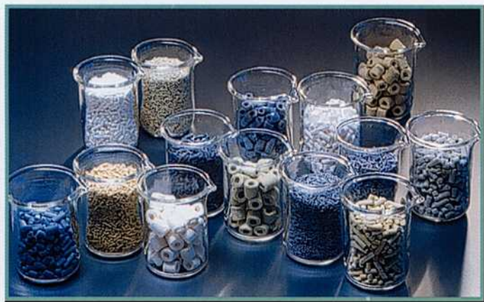
Fig. 5 Forskellige industrielt anvendte heterogene katalysatorer. Katalysatorerne er underkastet særlige formgivningsmetoder for at sikre optimal drift.
