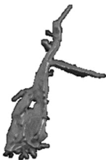
Figur 1: Billede fra elektronmikroskop af en primærkrystal i alumina (2 nm x 50 nm)
